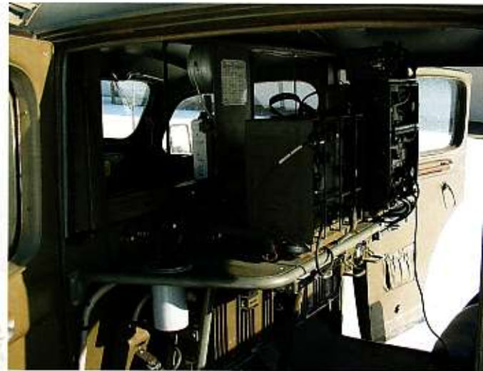
Complete radiotafel met links de RA120 en rechts de RA200. Onder de tafel twee transformators. Voor de verbindingssystemen de MT920 met box. Om de aanwezigheid niet te verraden, kan een blinding tussen de compartimenten naar beneden getrokken worden.
